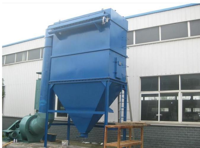
图7-1 袋式除尘器示例图
