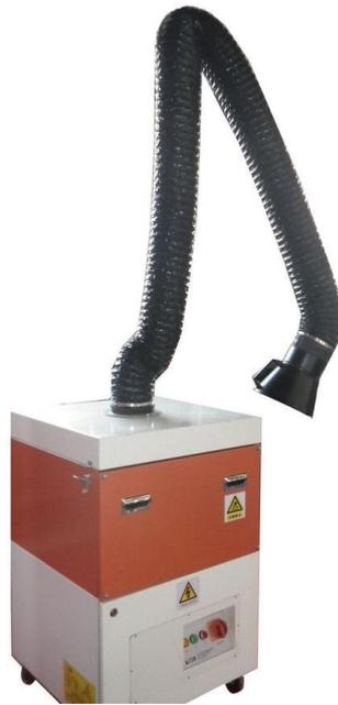
图 7-3 移动式焊接烟尘净化器示例图
