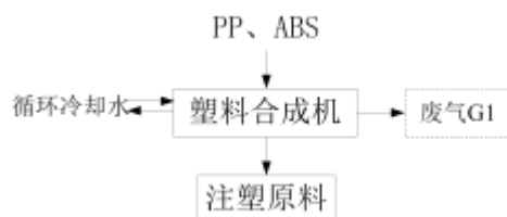
图 3.2-2 改性塑料生产工艺流程及产污环节
